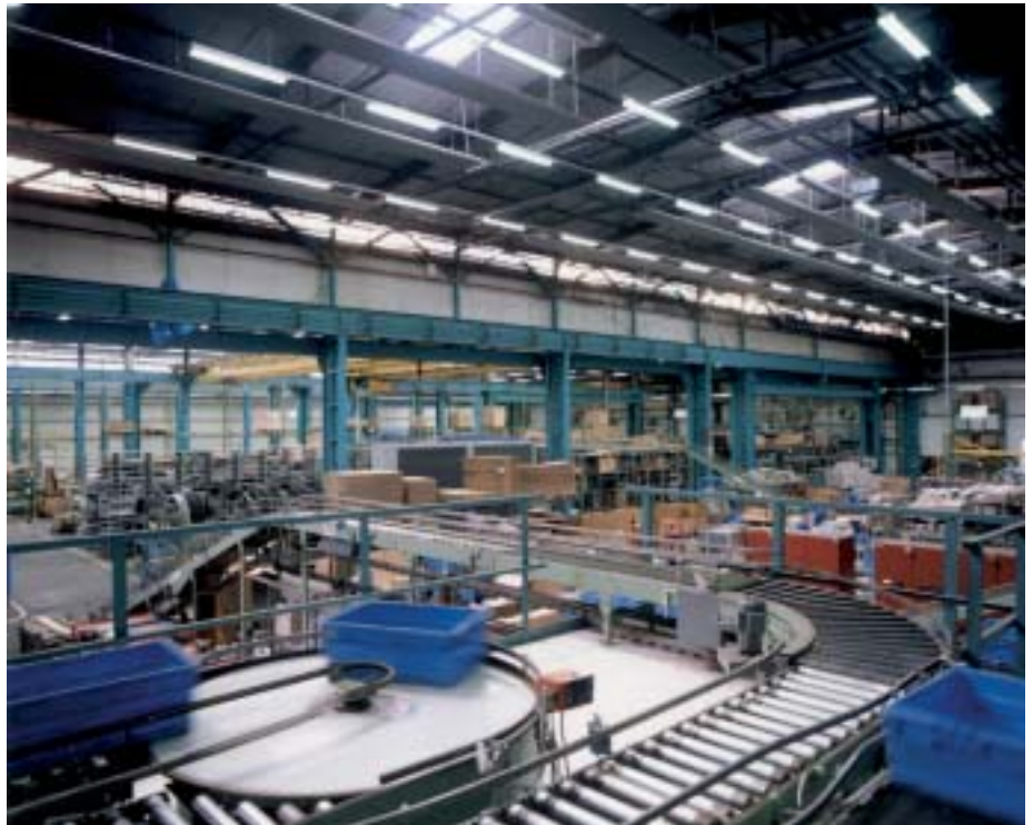
Bevor die Ware in den Versandbereich gelangt, werden die Teile aus den verschiedenen Lagerbereichen auf der Behälterbahn auftragsbezogen sortiert.
